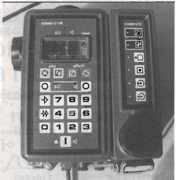
figura 3 - Primo piano dell'unità portatile (KSMG 1/1 M) montata sulla base (KSMG 1/1 Z). Sull'unità base, in basso a destra si nota il tappo circolare dell'alloggiamento per la ricarica della batteria di riserva. Tale alloggiamento è riscaldato per consentire la corretta ricarica anche in climi polari.
