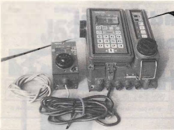
figura 2- Vista d'insieme dell'apparato KSMG con l'unità di misura montata sulla base e, a sinistra, l'unità ripetitrice remota KSMG 1/1A.
