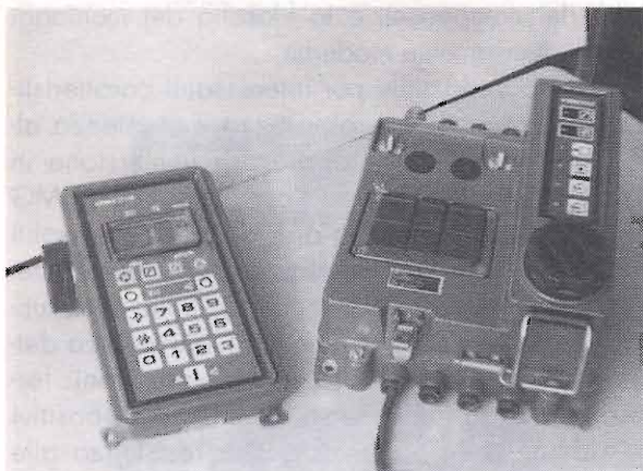
figura 4 - Vista d'insieme dell'apparato KSMG con l'unità di misura (a sinistra) separata dalla base. La comunicazione e la ricarica delle batterie avviene attraverso un sistema di trasmissione ad induzione che, privo di qualsiasi contatto, risulta molto affidabile e assolutamente stagno.
